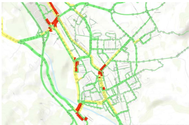
Assegnazione della matrice attuale (ora di punta della mattina 07:45 - 08:45) alla rete attuale - Flussi/Capacità (Area centro storico)
