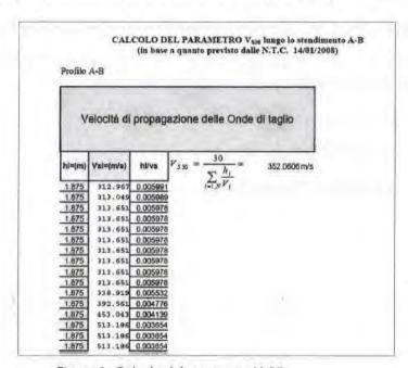
Figura 1: Calcolo del parametro Vs30
